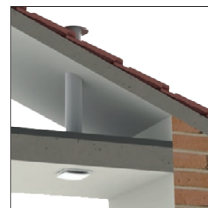
Installazione a soffitto
